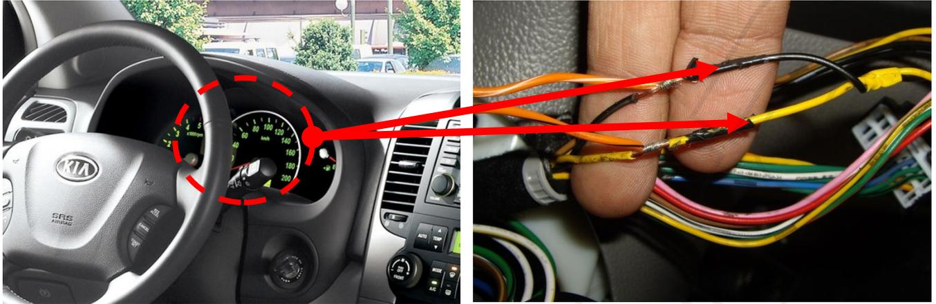
Для подключения к CAN-шине используйте жгут за приборной панелью.
