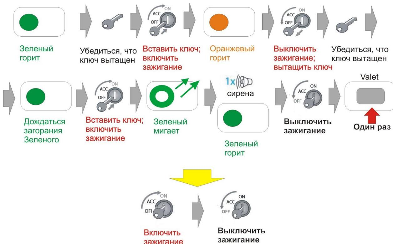
Система переведена в режим программирования бесключевого обхода штатного иммобилайзера - световой индикатор горит зеленым цветом, ключ из замка зажигания вынут.
